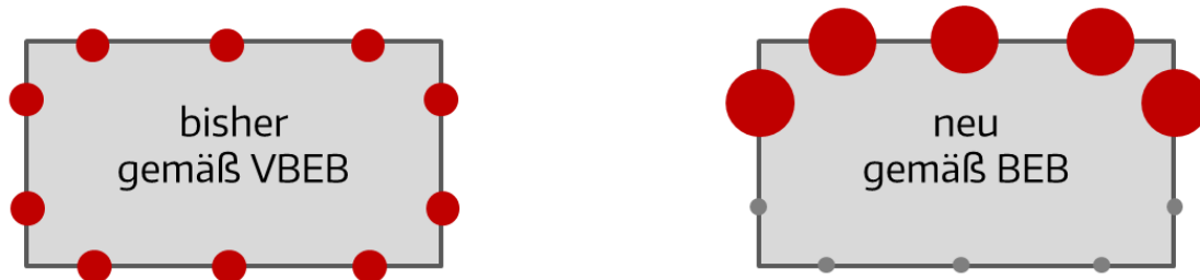
Abb. 7 Vergleich Bewohnerzuordnung zu den Fassadenpunkten VBEB / BEB
